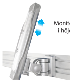
438-60T6 Monitorslider, max 3-5 kg, vertikal slaglängd 170 mm. 438-60T8 Monitorslider, max 5-7 kg, vertikal slaglängd 170 mm. Observera att Monitorslider är ett tillbehör till LA682/683.
